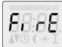
Durch Betätigen einer beliebigen Funktionstaste beenden Sie den Alarmmodus des Gerätes.
